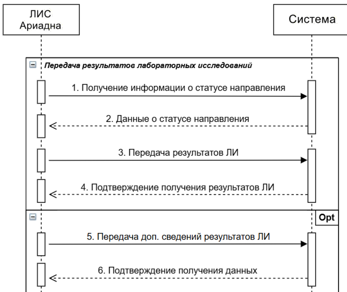
Рисунок 16 – Диаграмма взаимодействия при выполнении сценария "Передача результатов лабораторных исследований"
